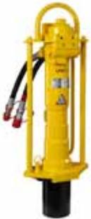
Se utilizan para la colocación de guardarrailes en carreteras, perfiles, postes de señales, vallas y una amplia variedad de anclajes. Los hincapostes ofrecen estabilidad, potencia y una alta velocidad de colocación para numerosos tamaños de postes. Cuando funcionan con la válvula accionada por control remoto montada en la manguera, se pueden conectar a circuitos hidráulicos abiertos o cerrados.
