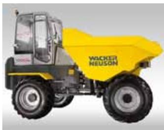
En la clase de potencia superior de 9,0 a 10,0 toneladas, Wacker Neuson apuesta por el concepto de tracción probado Powershuttle y Powershift, que naturalmente, se ofrece también con tracción en las cuatro ruedas.
