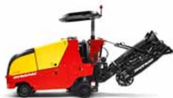
Fresadoras accionadas hidráulicamente, potentes, altamente maniobrables y diseñadas para anchos de fresado de 350 a 1000 mm con un rango de profundidad de entre 100 y 300 mm. Todas estas fresadoras en frío se ofrecen con tres o cuatro ruedas de tracción y con sistema de control no-spin. Equipadas con un sistema de descarga trasera fácilmente desmontable y diseñadas para trabajos de mantenimiento de carreteras y otras aplicaciones de fresado en asfalto y hormigón.
