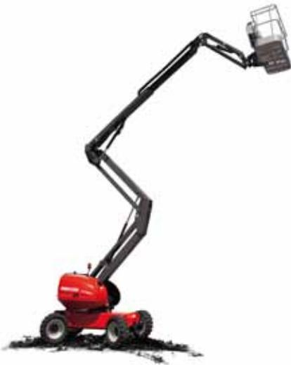
**Sencillez, robustez y capacidad todoterreno.** Conjugando una excelente motricidad todoterreno y una elevación en altura rápida, le ofrece alturas de trabajo de hasta 20 metros y un alcance excepcional. Todas las configuraciones de trabajo son posibles gracias a sus avanzadas articulaciones, a los tramos telescópicos y a su gran maniobrabilidad. En la gama se pueden encontrar modelos diesel, eléctricos y mixtos (bi-energéticos).
