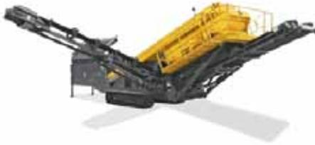
Poseen gran capacidad de cribado, lo que las hace perfectas para su uso en canteras, minas y construcción. Estas Cribadoras se usan como complemento a las Trituradoras para clasificar el material que sale de las mismas o bien pueden ser alimentadas de forma independiente por una pala cargadora. Pueden equipar unas rejillas vibratorias que mejoran aún más la capacidad de cribado, permitiendo obtener un producto adicional.
