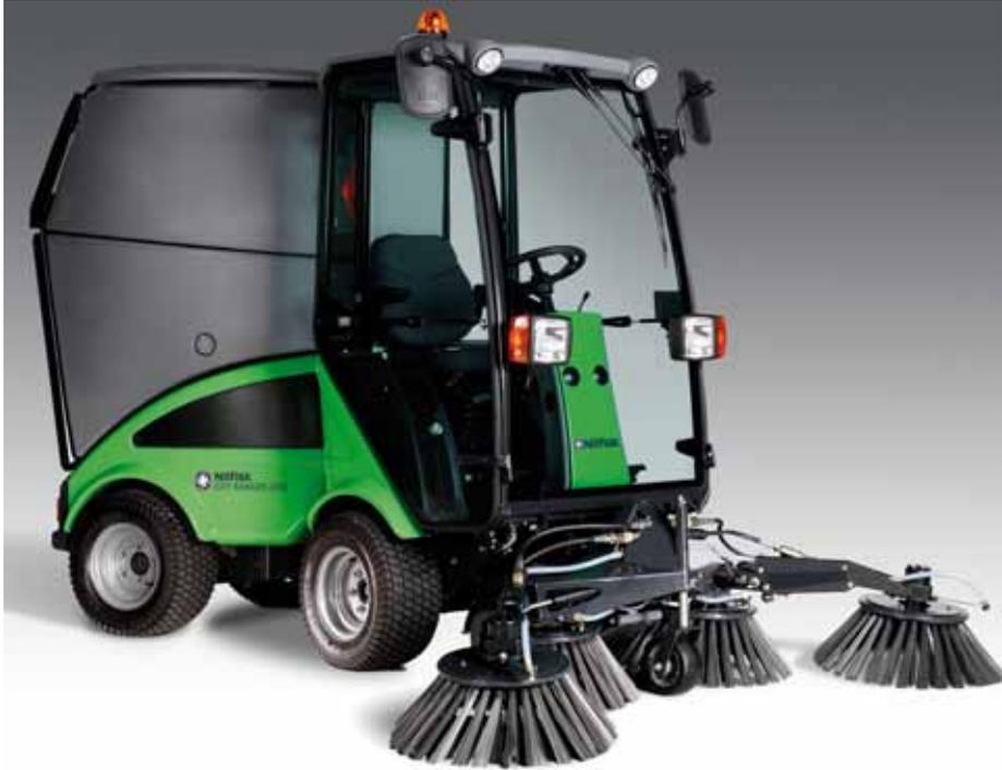
**Estas máquinas articuladas ofrecen la máxima flexibilidad y permite trabajar en los sitios más estrechos, Motor Diesel Perkins y Tracción 4x4. Gran gama de accesorios tales como: Barredora de aspiración, Pala quitanieves, Cortacesped, Remolque, Pala basculante, esparcido de sal y gravilla, Cepillo giratorio....**
